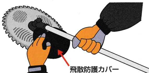
飛散防護カバーは作業の方へ異物が飛んでくるのを防ぎます。外して使用すると事故を招く恐れがあります。
