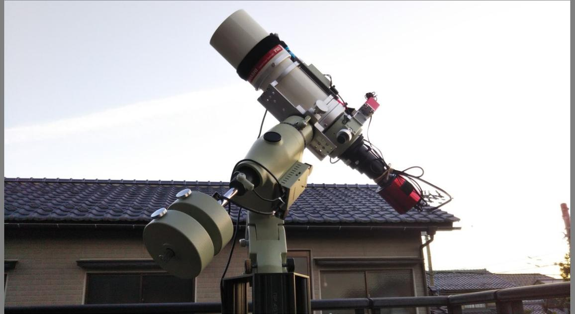
望遠鏡：口径106mm、焦点距離850mm・510mm・385mm可変
